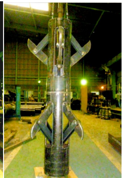
杭を地中に埋設した後の最終形態
